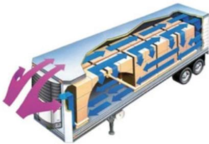
**Um bei einem Kühltransport eine optimale Kühlleistung zu erreichen, ist es absolut notwendig, dass die Luft im Laderaum zirkulieren kann.**
