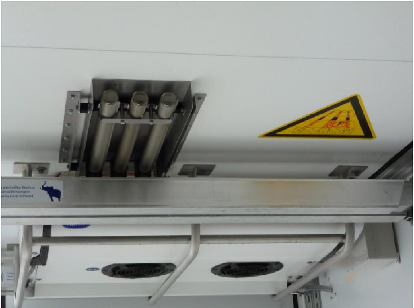
Die Anlage für den zweiten Verdampfer im hinteren Bereich des Trailers ist im Ausblasluftstrom verbaut. Auch hier ist die Anlage sicher und platzsparend verbaut
